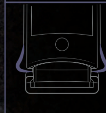
Bocchettone caricatore svasato e fondello caricatore maggiorato
